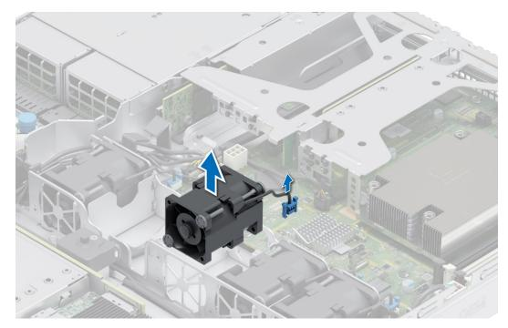
Figure 15. Removing a cooling fan
