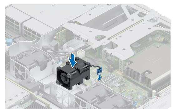
Figure 16. Installing a cooling fan
