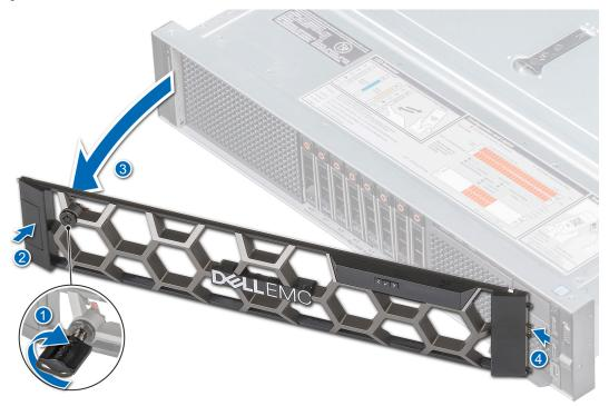
Figure 17. Removing optional front bezel
